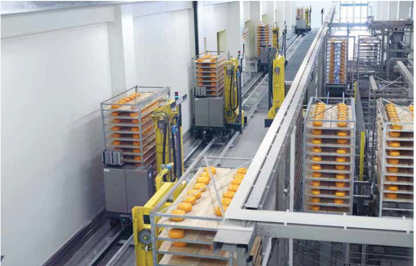
Het WMS stuurt de interne verplaatsing aan van de kazen in rijping tot bij de volautomatische kaasbehandelingslijnen.
